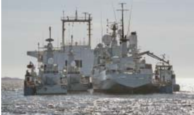
Fartygen har bogseras in i Eide Trader och hon fungerar i princip som en flytdocka. Foto Ingmar Elofsson
